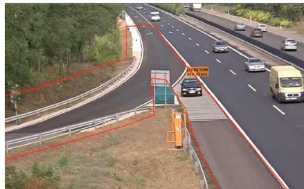
etc. Dabei verfolgt der Algorithmus einzelne Fahrzeuge im zuvor definierten Bereich und misst, wie lange eines davon gegebenenfalls innerhalb des Bereiches stehen bleibt. Wenn ein Fahrzeug länger als den festgelegten Toleranzzeitraum bewegungslos bleibt, löst iCAT Traffic einen Alarm oder Benachrichtigungen aus, damit die Mitarbeiter der Verkehrszentralen entsprechend reagieren können.
