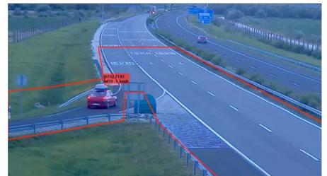
Für die Wrong Way Detection muss der zu beobachtende Straßenabschnitt 50 - 60 Meter lang sein. Die Kamera muss zumindest eine VGA Auflösung und eine Bildrate von 12fps liefern, wobei hoch-qualitative Kameras empfohlen werden. Um verlässlich erkannt zu werden, müssen Fahrzeuge an der von der Kamera am weitesten entfernten Position zumindest 6% jeder Bilddimension (Höhe und Breite, bei VGA ca. 40x40 Pixel) abdecken.
