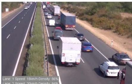
Für Traffic Monitoring muss der angezeigte Straßenabschnitt mindestens 100 Meter lang sein und der zu analysierende Teil davon sollte gerade und 70 - 100 m lang sein, und bis zu drei Fahrspuren haben. Es empfehlen sich hoch qualitative Kameras mit mindestens
