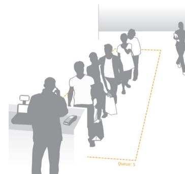
Kassen, Informationsschaltern oder ähnlichen Situationen. Wenn ein zuvor konfigurierter Schwellenwert erreicht wird, kreiert Queue Length Detection ein Event das als Trigger für Lautsprecherdurchsagen, Signale für Mitarbeiter zur Eröffnung einer neuen Kasse und viele andere Prozesse verwendet werden kann.
